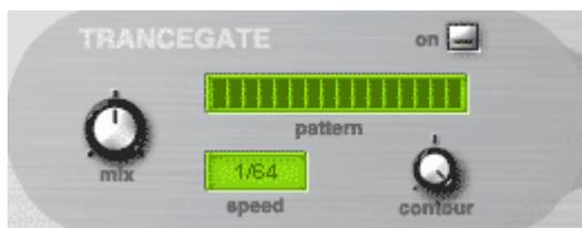
Этот блок предназначен для создания типичных трансовых звуков. Поле зеленого цвета разбито на 16 участков, долей которые можно включать и выключать мышью. Таким образом на включенных участках звук будет проигрываться, а на отключенных будет затухать по амплитуде. С помощью регулятора "mix" можно регулировать глубину затухания сигнала, то есть чем ниже значение тем звук менее затрагивается и соответственно наоборот, чем значение выше тем больше затухание пропущенного сегмента звука.
