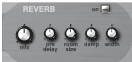
Эффект реверберации эмитирует распространение звука в каком либо помещении, то есть отражение сигнала от стен. Этот блок так же представляет классический ревербиратор. Назначение органов управления:
