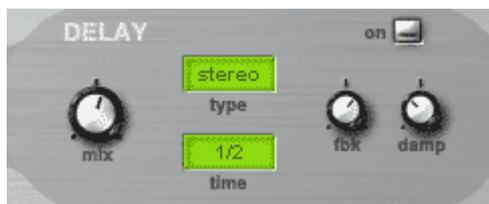
Блок задержки здесь представлен в классическом варианте. Если вы уже работали с эффектом delay - то все вам здесь должно быть знакомо. Регулятор "mix" - отвечает за смешивание прямого и задержанного во времени сигнала. Так же есть возможность выбрать один из четырех "тип" типов задержки: "mono", "stereo", "widen" и "cross".
