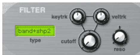
VANGUARD имеет 13 различных типов фильтров, включая стандартные низко и высоко частотные фильтры, а так же их разновидности. Для выбора фильтра надо нажать на зеленое поле указателем мыши и мы получим список всех 13 доступных типов фильтров. Блок фильтра имеет четыре регулятора:
