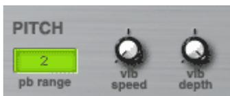
В этой секции можно настроить действия колеса pitch на вашей midi клавиатуре - если конечно у вас есть. Регулятор "pb range" - устанавливает диапазон сдвига тона при прокручивании колеса на полный оборот, можно выставить значение от 0 до 12 полутонов.
